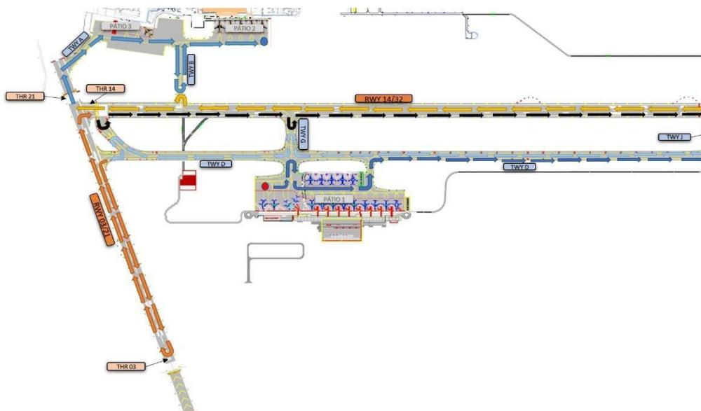
Figura 14 – Rota para inspeções de pista com drone.
